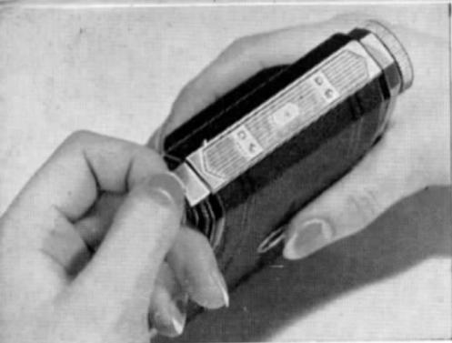
den am Cameraboden angebrachten Federzapfen heraus und setzt die Filmrolle in das untere Spulenlager der geöffneten NETTAR.
